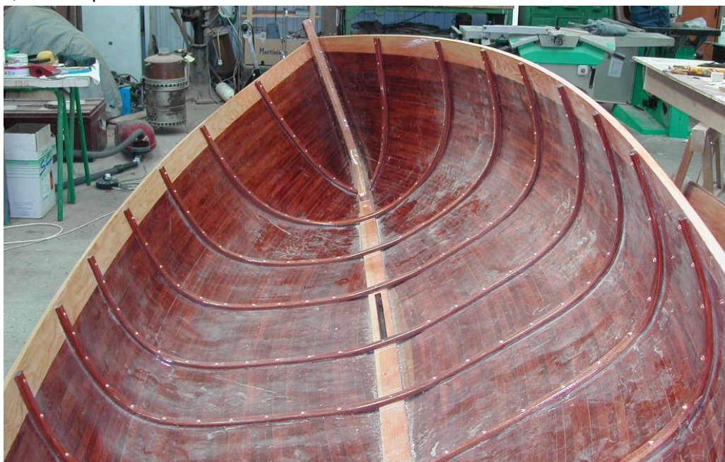
Ilur après pose des membrures lamellées in-situ © Jean-François Dockes
