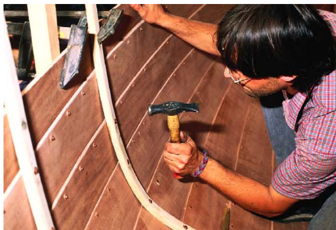
Construction d'un Ilur à clin et membrures ployées : matage des rivets. © Francis Holveck à Douarnenez
