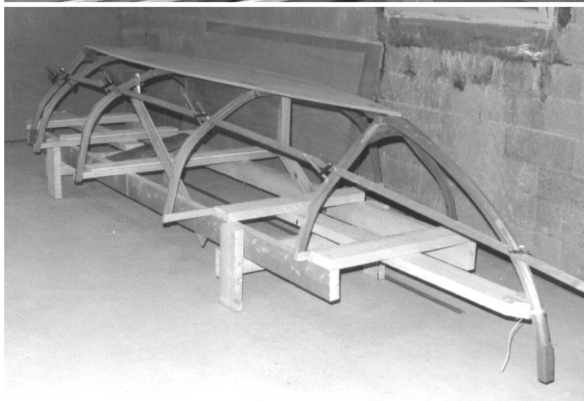
Youkou-Lili : construction sur membrures avec sole. L'arrière pointu se traite exactement comme l'étrave. Une latte est présentée pour vérifier les équerrages de membrures et d'étrave.
